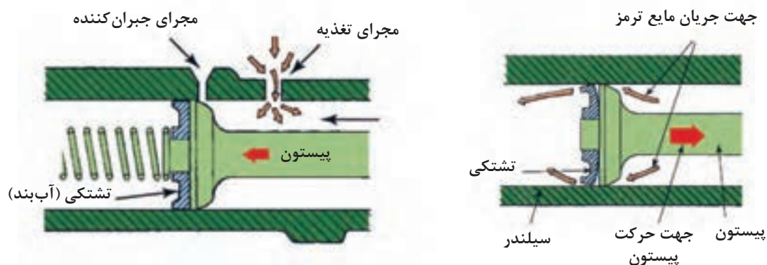
شکل ۱۲- عملکرد تشتکی پیستون
