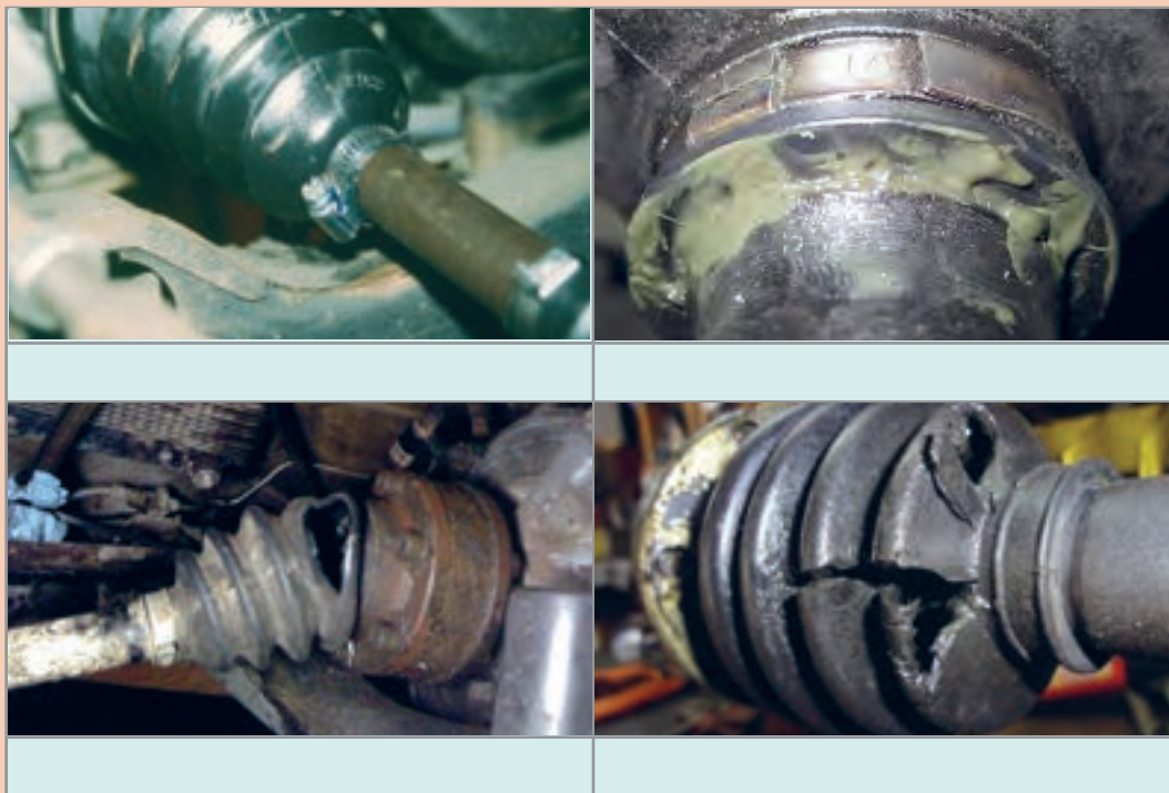
شکل ۱۷-۵- روش بررسی ظاهری پلوس‌ها
