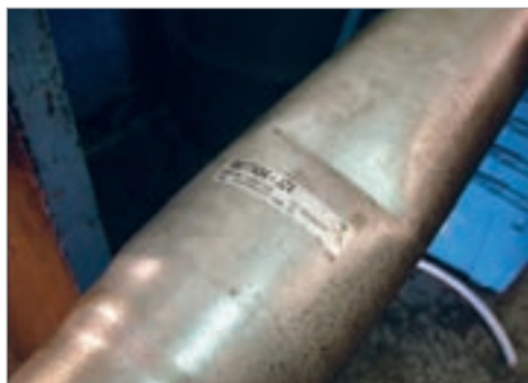
شکل ۱۵-۳- مشاهده آثار ضربه روی سطح میل گاردان
