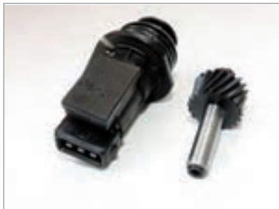
شکل ۲۲-۲- حسگر سرعت خودرو روی جعبه‌دنده
