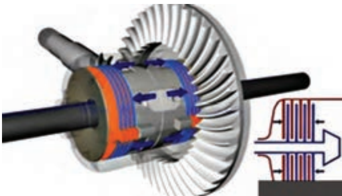
شکل ۴-۵ عملکرد دیفرانسیل ضد لغزش
