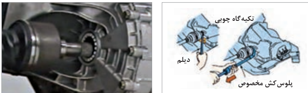
شکل ۱۹-۵- خارج کردن پلوس با ابزار مخصوص
