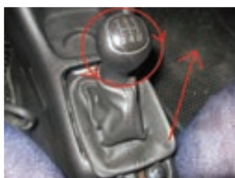
شکل ۲-۲۵- خارج کردن سری و گردگیر دسته دنده
