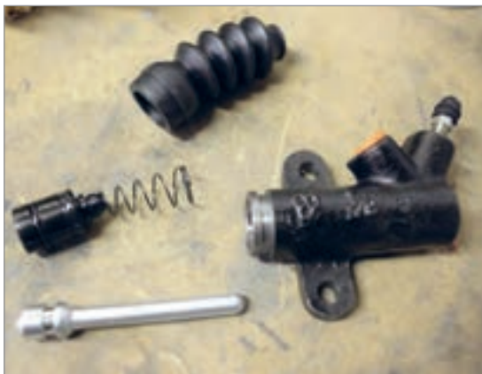
شکل ۲۴-۱- اجزای سیلندر اصلی کلاچ
