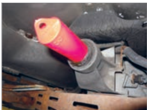
شکل ۳-۱۹- استفاده از ابزار مخصوص کورکن
