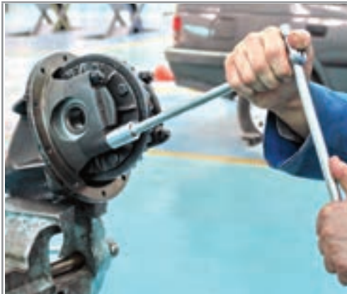
شکل ۵۳-۴- بستن کپه یاتاقان‌ها
