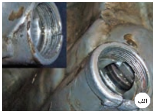
شکل ۲-۳۴- پوسته جعبه‌دنده و نحوه ترمیم آن
