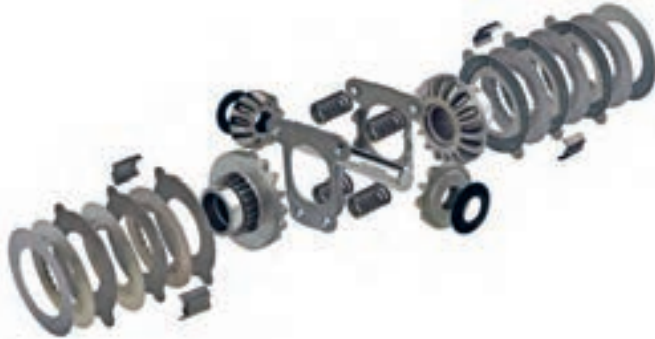
شکل ۴-۴ اجزای دیفرانسیل ضد لغزش
