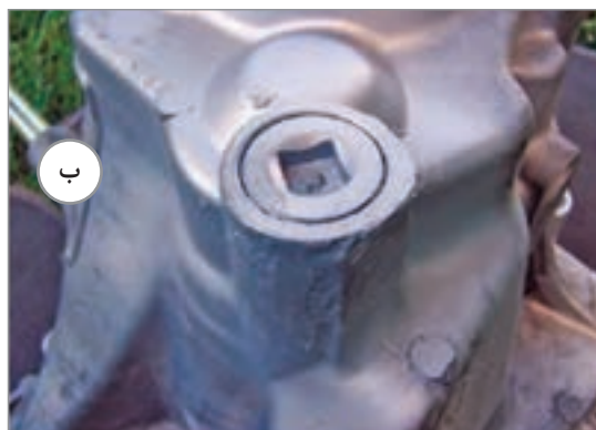
شکل ۲-۳۴- پوسته جعبه‌دنده و نحوه ترمیم آن
