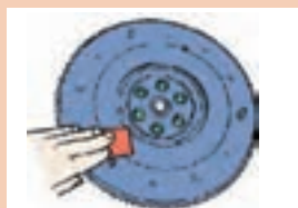
شکل ۳۲-۱- نحوه برطرف نمودن عیوب جزئی سطح فلاپیول
