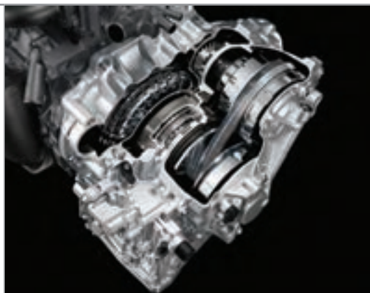
جعبه دنده اتوماتیک - CVT
