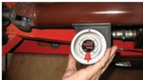
شکل ۱۳-۳- روش استفاده از زاویه سنج میل گاردان
