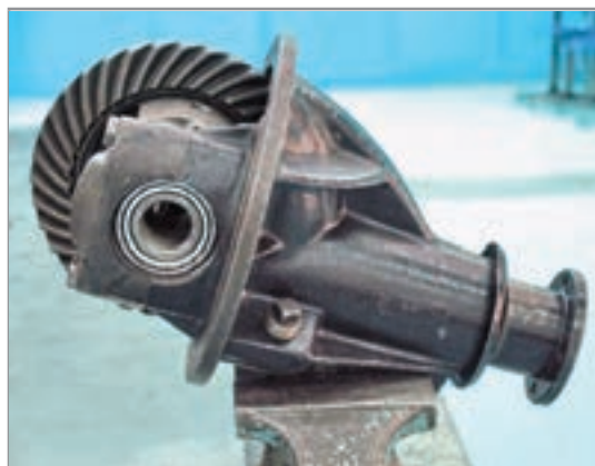
شکل ۴-۲۷- بستن مجموعه دیفرانسیل روی گیره
