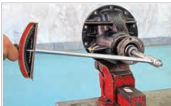
شکل ۴۸-۴-ب تعیین گشتاور پیش بار با گشتاورسنج
