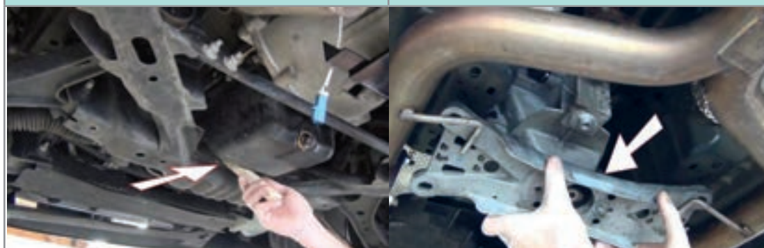
جلوگیری از افتادن موتور بر روی رام و استفاده از نگهدارنده چوبی یا لاستیکی
