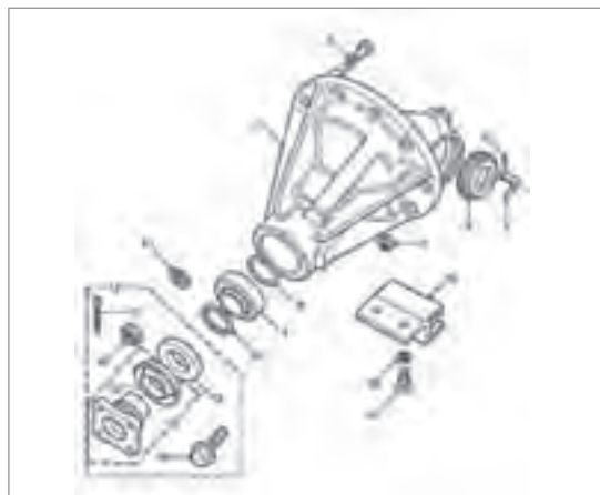
شکل ۱۴-۴ اجزای دیفرانسیل عقب
