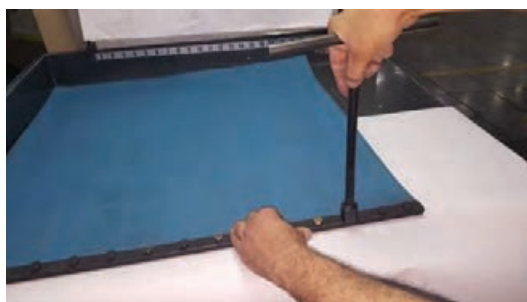
شکل ۶۰- نصب گیره لاستیک
