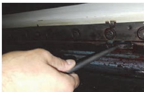
شکل ۸۱- پیچ تنظیم لبه کار
