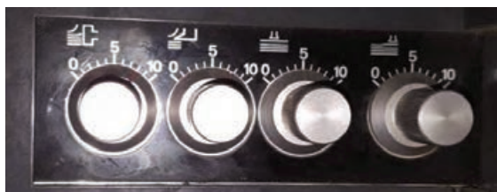
شکل ۱۹- شیرهای تنظیم باد
