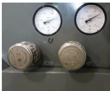
شکل ۴۲- شیر تنظیم مکش (شیر سمت چپ)
