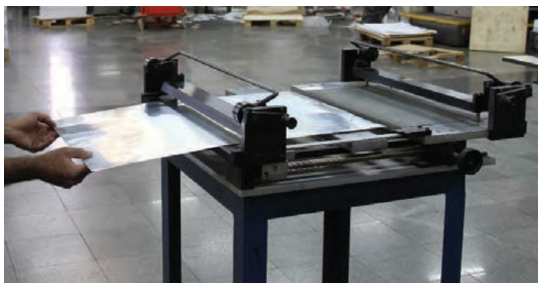
شکل ۶۲- قرار دادن پلیت در دستگاه خم‌کن
