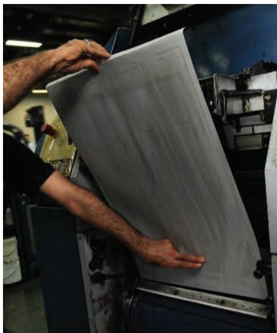
شکل ۵۷- درآوردن پلیت از درون شیار چفت
