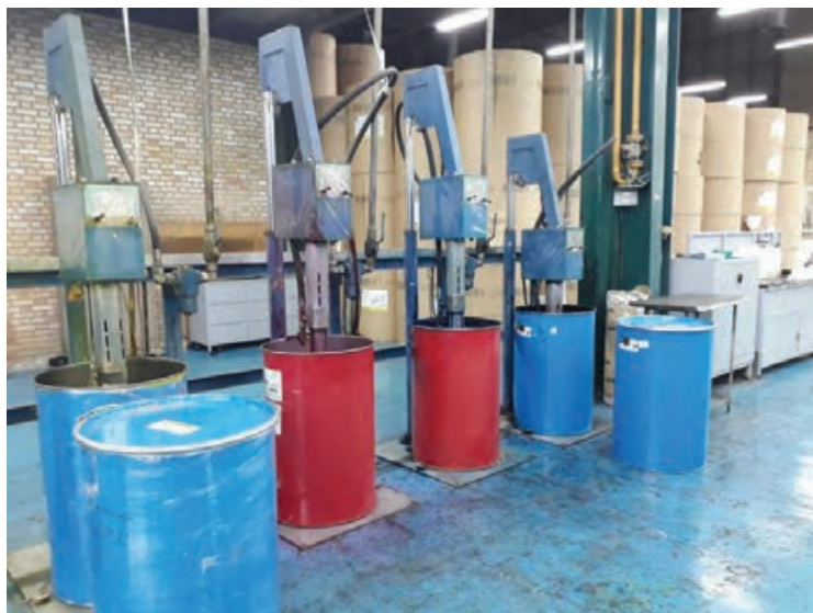
شکل ۷۷- مکانیزم تغذیه خودکار مرکب
