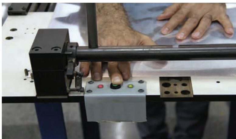
شکل ۶۰- حسگرهای لب کار پلیت
