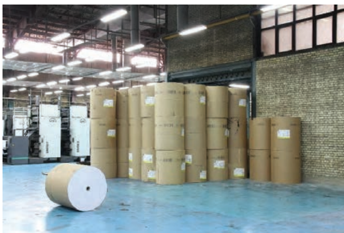
شکل ۱- حالت درست قرار گرفتن رول‌های کاغذ
