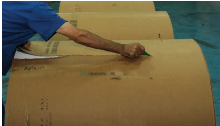
شکل ۳- باز کردن لفاف
