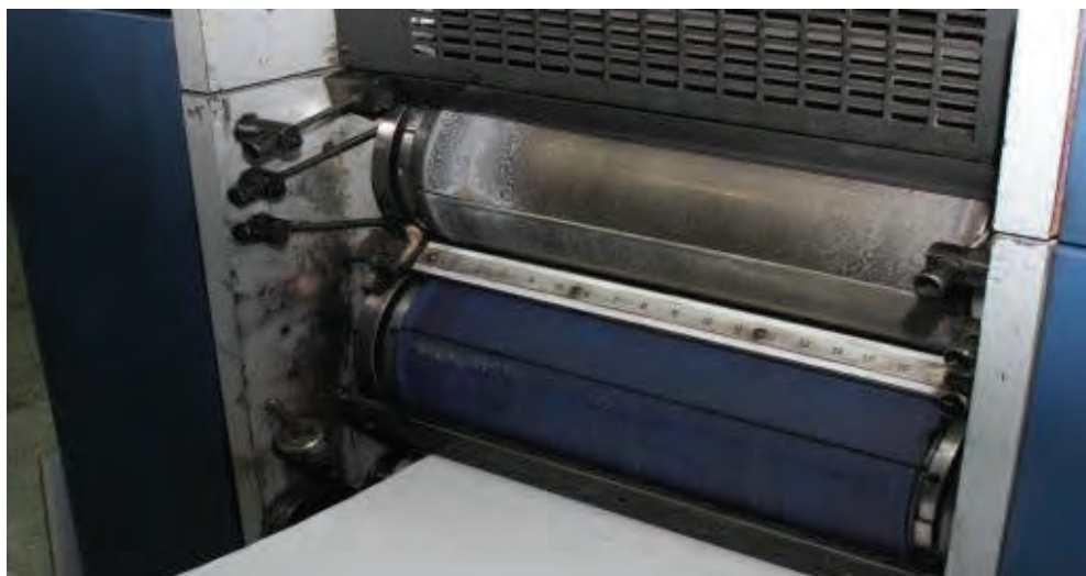
شکل ۶۸- سیلندر آماده بستن پلیت
