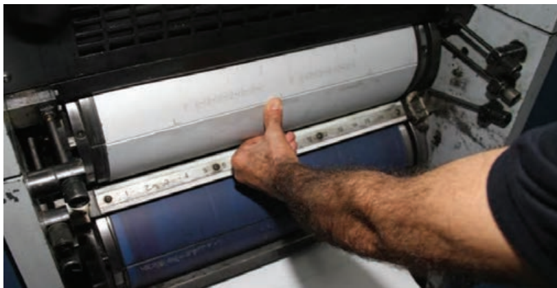
شكل ۷۱- قرارگيري ته كار پليت در شيار سيلندر
