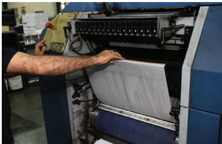
شکل ۵۶- نگاه‌داشتن پلیت برای بازکردن از روی سیلندر
