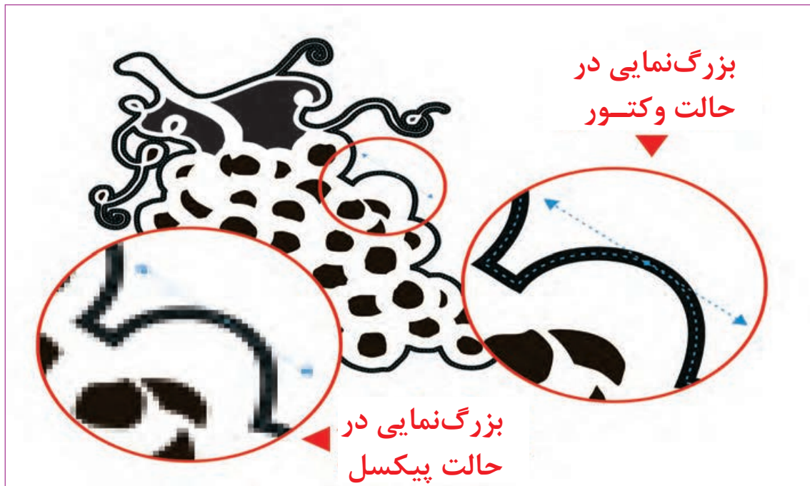
ساختار کلی تصاویر دیجیتال در دو حالت وکتور و پیکسل
