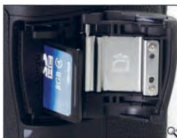
محل نصب کارت حافظه بر روی دوربین
