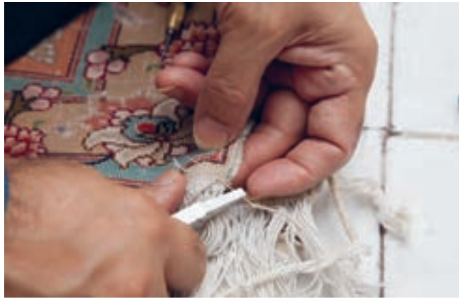
تصویر ۴۹- مراحل اتصال قیطان به لبه قالی ▲
