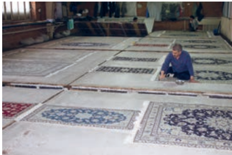
تصویر ۴- دارکشی با میخ و چنگک ▲
