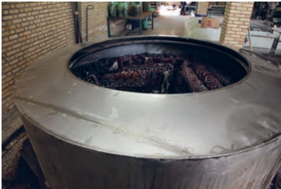
تصویر ۱۰- دستگاه آبگیری دیگی فرش ▲
