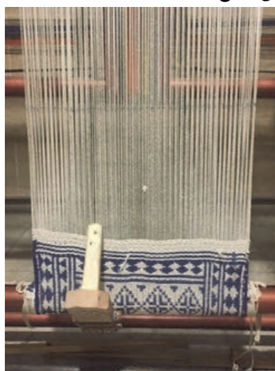
شکل ۷۹- جمع کردن زیلو بر روی تیر پایین
