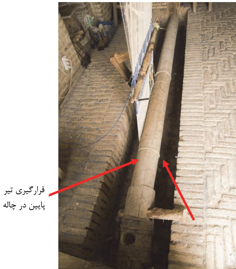
شکل ۴۷- چاله، محل قرارگیری دستگاه زیلوبافی چوبی
