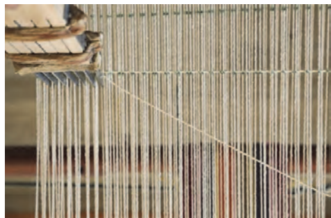
شکل ۷۱- کوبیدن پود به وسیله پنجه
