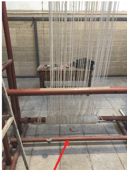
شکل ۴۴- تنظیم چله‌ها به کمک شاغول
