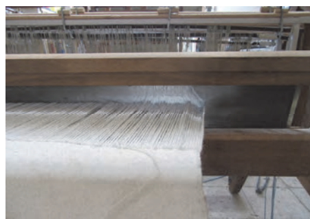
شکل ۱۸ - شانه دستگاه بافت پارچه
