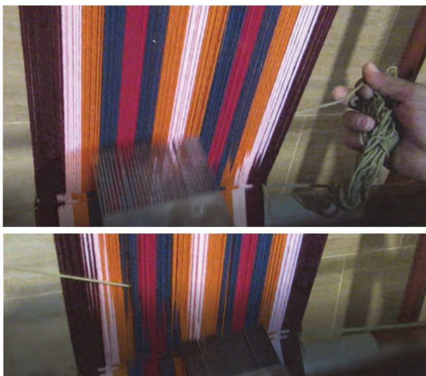
شکل ۲۲- کوبیدن پود در هنگام بافت
