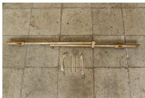
شکل ۷۴- قطعات پهنابند
