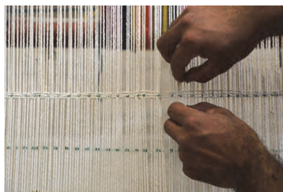
شکل ۷۲- مرتب کردن و تنظیم فاصله چله‌ها
