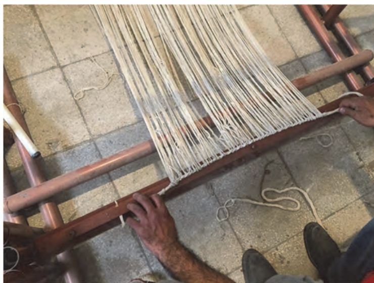
شکل ۴۱- بستن چله بر روی تیر پایین
