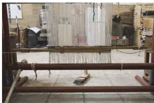
شکل ۷۷- مهرار پهنابند و بستن آن به کار
