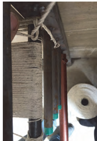
شکل ۳۳- عبوردادن نخ به صورت حلقه‌ای در سرکار شکل ۳۴- عبور دادن نخ به صورت زیگراگ در ته کار
