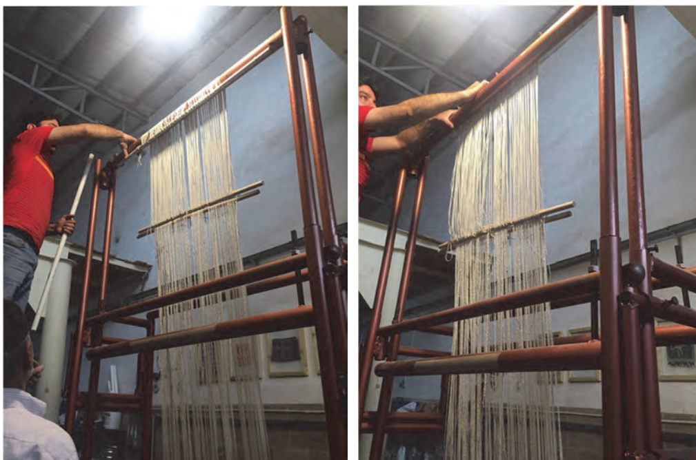
شکل ۴۳- بستن چله‌ها بر روی تیر بالا
