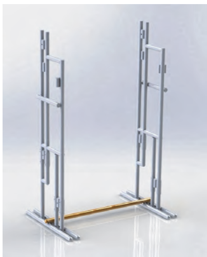
شکل ۵۷-قرار دادن مهار پایین
