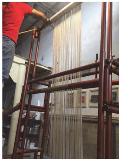
شکل ۴۵- برگرداندن چله‌ها بر روی تیر بالا
