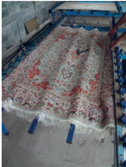
▲ تصویر ۱۷- مراحل بستن قالی بر روی دستگاه دارکشی پرسی مرحله ۱
