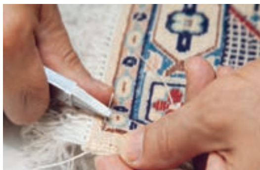
تصویر ۴۵ - تنظیم کشش نخ هنگام دوخت ▲
