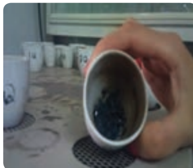
شکل ۲-۱۶- وسایل مورد استفاده برای آزمایش اندازه‌گیری خاکستر
