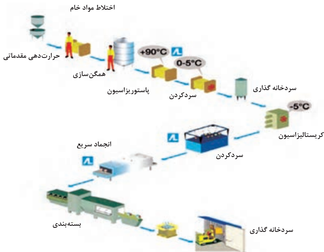
شکل ۳-۸ - فرایند تولید بستنی
