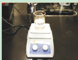
همزدن محلول به روش دستی و همزن الکتریکی
