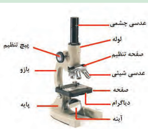
شکل ۲۳- اجزای مختلف نوعی میکروسکوپ
