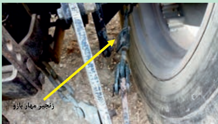
شکل ۲۴- زنجیره مه‌ار. برای تنظیم تعادلی
