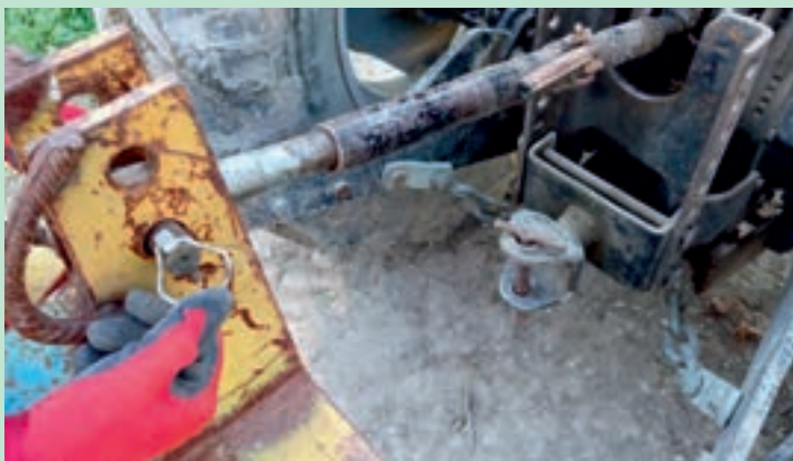
شکل ۲۳- اتصال بازوی وسط تراکتور به نه‌رکن
