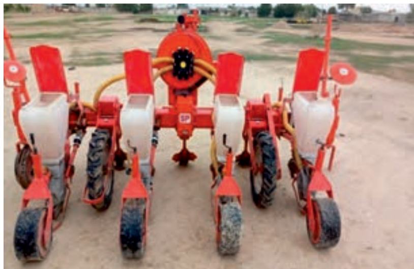
شکل ۲- ردیف کار پنوماتیکی تک دانه کار (با حذف بخش کود کار)
