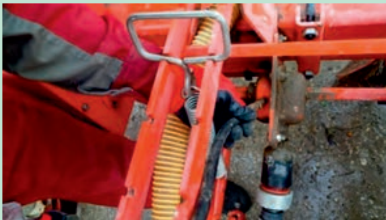
شکل ۱۲- گریس‌کاری تمام گریس‌خوره‌های ماشین ردیف‌کار
