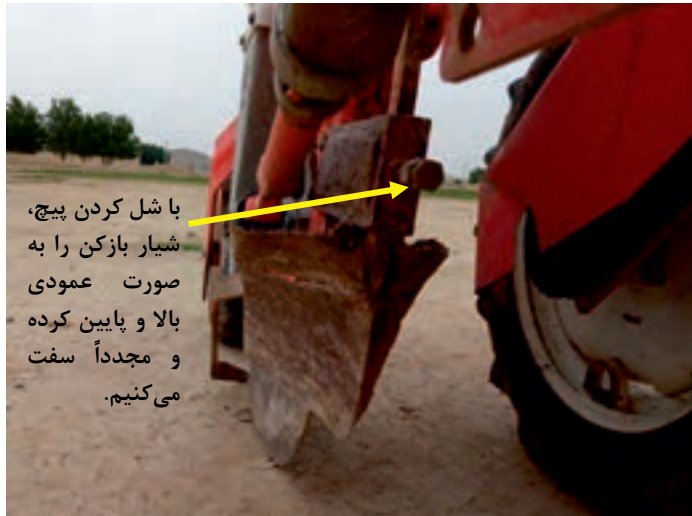
شکل ۲۰- تنظیم شیار بازکن
