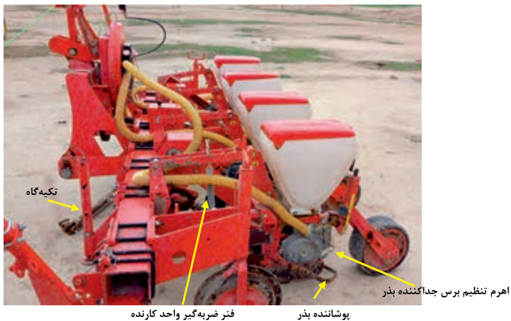
شکل ۸- ساختمان ردیف‌کار پنوماتیکی بدون کودکار از پهلوی دستگاه
