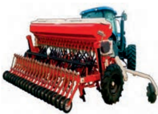
شکل ۳۴- کودکار وبذرکار کاشت مستقیم دیم مدل: KBDFN-21-21-420+P
