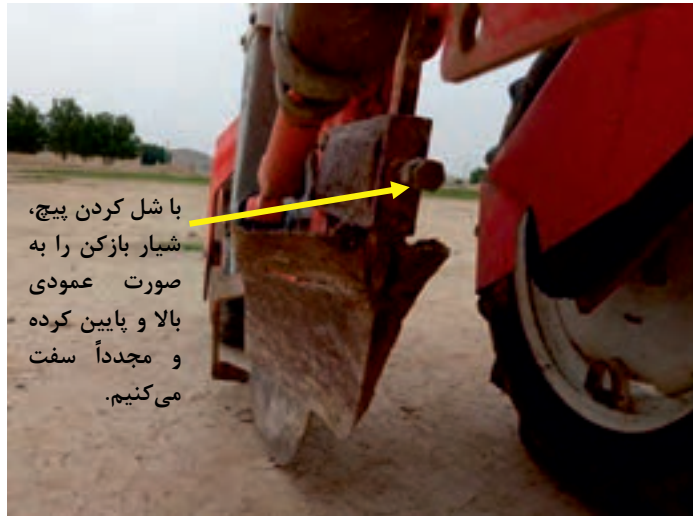
شکل ۲۰ - تنظیم شیار بازکن
