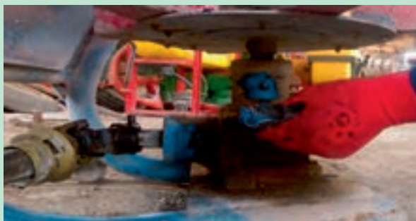
شکل ۱۳- تمیز کردن گریسخورها و مکان آنها
