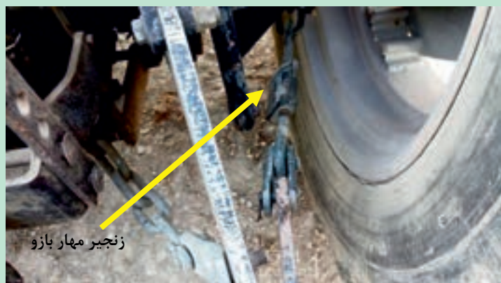
شکل ۲۴- زنجیر مه‌ار. برای تنظیم تعادلی
