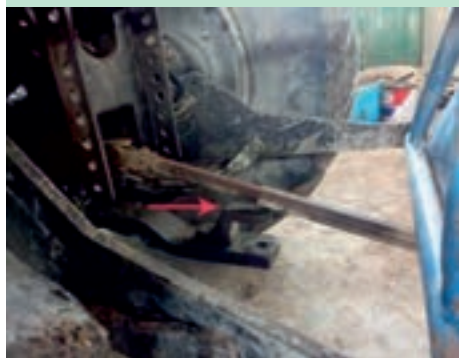
شکل ۷- کنار زدن مالبند ثابت
