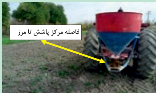
شکل ۱۹- کنترل فاصله پاشش بذر
