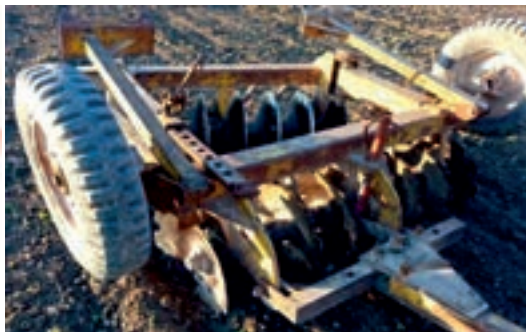
شکل ۴- دیسک آفست کششی
