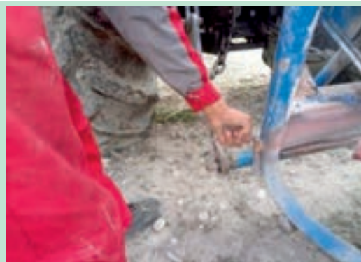
شکل ۸- اتصال بذرپاش به بازوهای کناری تراکتور
