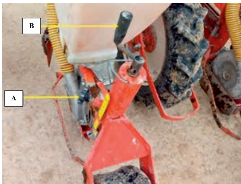
شکل ۲۱- تنظیم چرخ فشار دهنده
