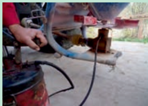
شکل ۱۵- گریس کاری گاردان و بذریاش
