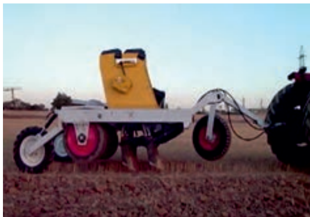
شکل ۴۷- خطی کارهای سوار و کششی در دیم‌کاری
