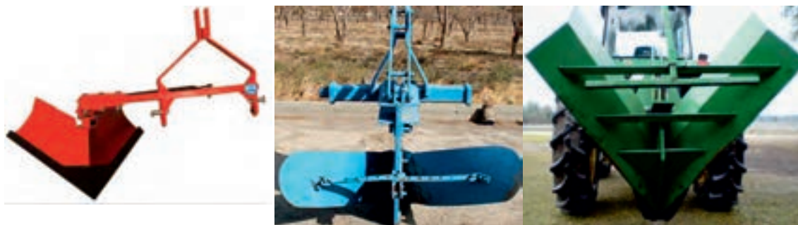
شکل ۲۰- انواع نه‌رکن سوار: ثابت - قابل تنظیم - کناری
