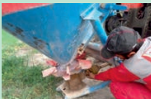
شکل ۹- نصب گاردان بین بذرپاش و تراکتور
