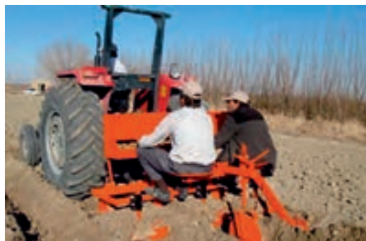
شکل ۳۲- غده‌کار نیمه خودکار دو ردیفه
