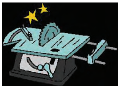
شکل ۳۱- نبود حفاظ در محل های متحرک دستگاه
