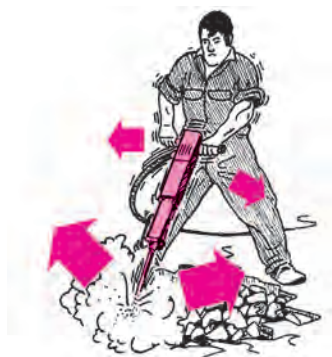
شکل ۳- عوارض ناشی از ارتعاش
