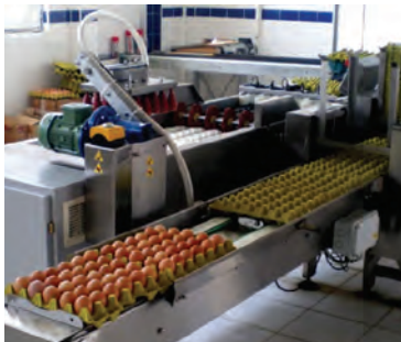
۳. انتقال تخم‌مرغ به شانه ستر به روش خودکار
