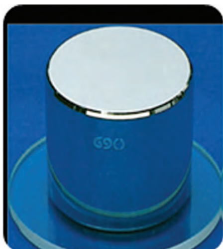
شکل ۱- استاندارد کیلوگرم فلزی از جنس پلاتین - ایریدیوم است که به‌صورت قراردادی جرم آن را معادل ۱ کیلوگرم تعریف کرده‌اند.
