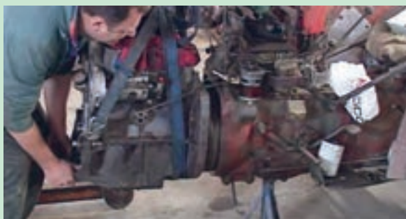
شکل ۳۲. جدا کردن موتور از جعبه دنده
