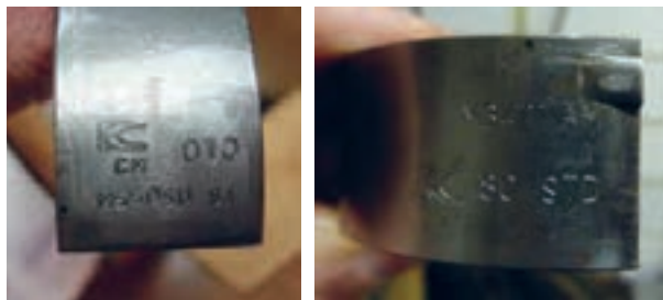
شکل ۲۳. تغییر ضخامت یاتاقان در سایزهای مختلف
