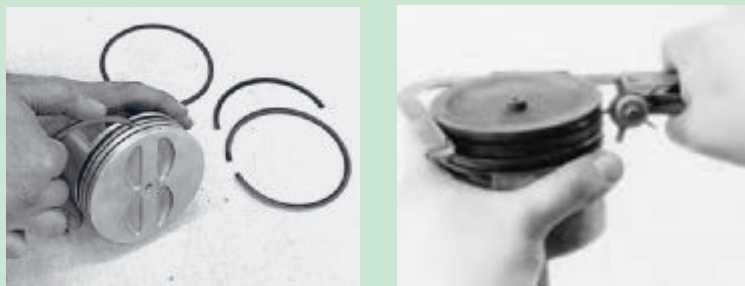
شکل ۵۸. روش های تمیز کردن شیار رینگ پیستون
