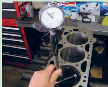
شکل ۷۶. اندازه‌گیری قطر سیلندر با میکرومتر داخلی
