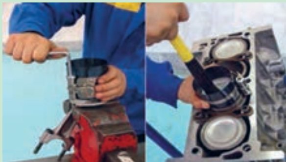
شکل ۹۹. وارد کردن پیستون به داخل سیلندر شکل ۱۰۰. علامت روی پیستون
