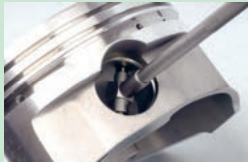
شکل ۸۱. اندازه گیری لقی گزن بین در پیستون
