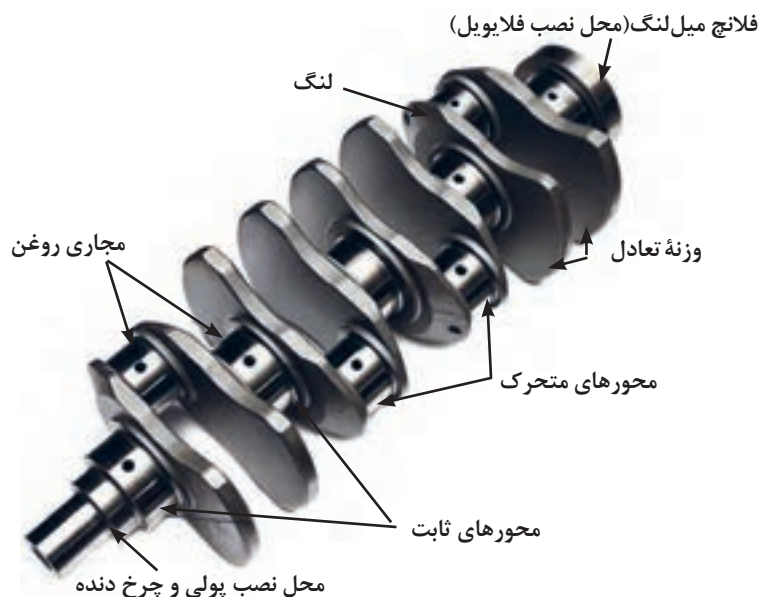
شکل ۱۶. اجزاء میل لنگ
