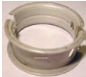
الف- بغل یاتاقانی یک تکه با یاتاقان
