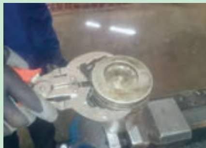
شکل ۵۲. نحوه خارج کردن رینگ از روی پیستون
