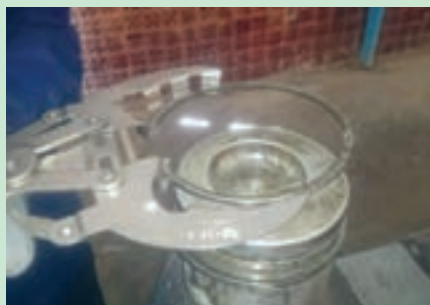
شکل ۵۲. نحوه خارج کردن رینگ از روی پیستون
