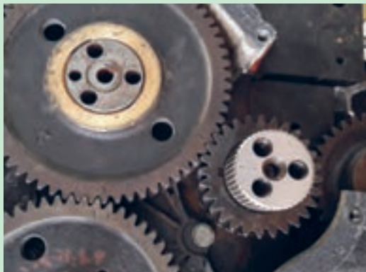
شکل ۱۰۹. علامت‌های تایمینگ روی چرخ دنده ها
