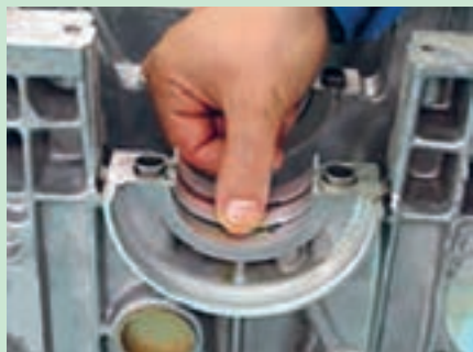
شکل ۵۰. برداشتن یاتاقان های ثابت و بغل یاتاقانی
