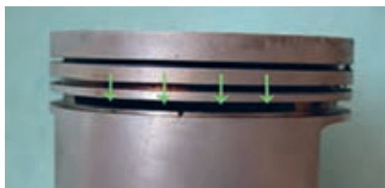
شکل ۹. ترتیب قرار گرفتن رینگها و موقعیت شیار عرضی پیستون زیر ناحیه قرار گرفتن رینگ روغنی
