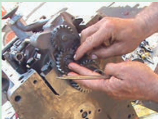
شکل ۱۰۵. نصب خار گرد روی محور چرخ دنده واسط
