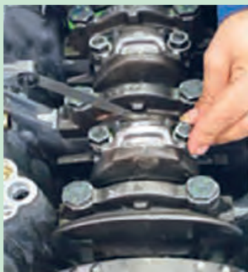
شکل ۱۰۲. کنترل لقی شاتون روی محور میل لنگ
