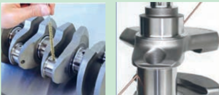
شکل ۶۰. تمیز کردن مجاری میل لنگ
