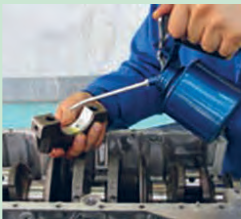
شکل ۹۵. روغنکاری یاتاقان ها قبل از نصب
