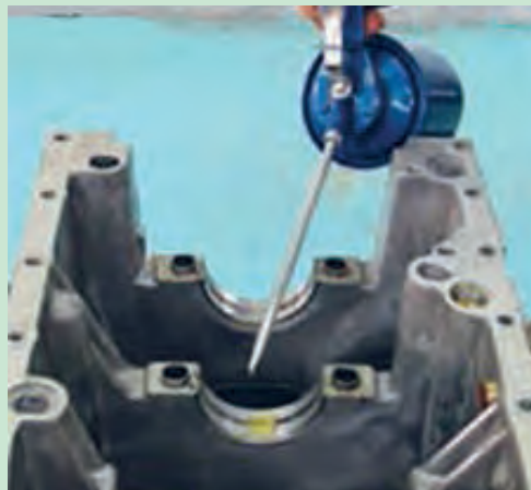
شکل ۹۵. روغنکاری یاتاقان ها قبل از نصب
