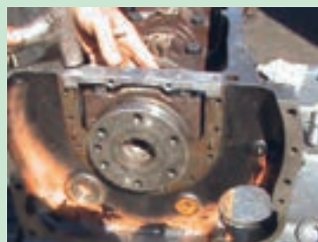
شکل ۹۷. جا زدن قطعه آب بندی کارتر
