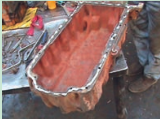
شکل ۱۱۴. جسابندن واشر کارتر
