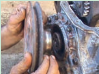
شکل ۳۵. پیاده کردن پولی میل لنگ
