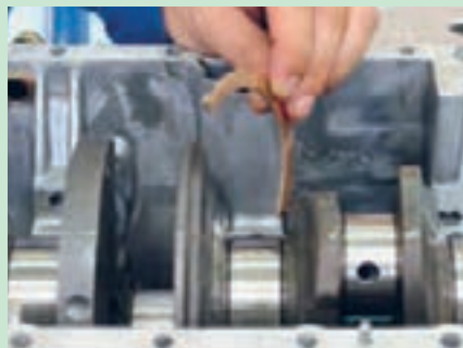
شکل ۵۰. برداشتن یاتاقان های ثابت و بغل یاتاقانی
