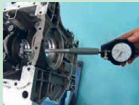
شکل ۶۳. کنترل دو په‌نی تکیه‌گاه‌های میل‌لنگ
