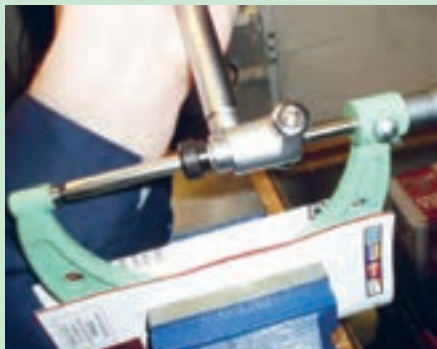
شکل ۷۶. اندازه‌گیری قطر سیلندر با میکرومتر داخلی
