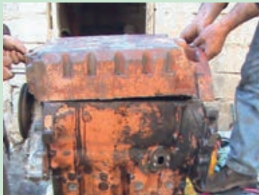
شکل ۱۱۵. نصب کارتر روی بلوکه سیلندر
