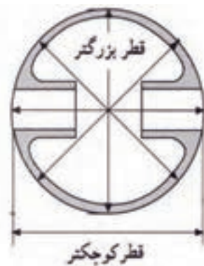
شکل ۷. اندازه قطر های پیستون
