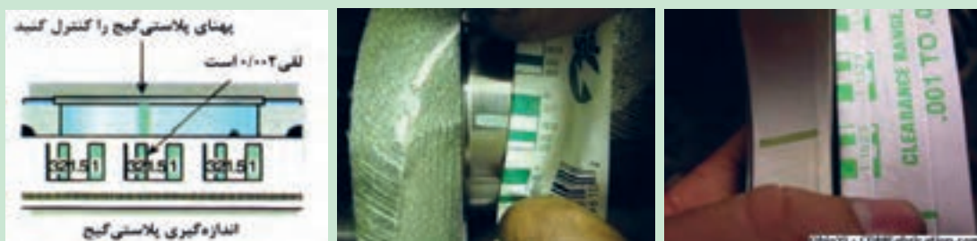
شکل ۸۷. مطابقت شاخص پلاستی گیج با اثر پلاستیک روی میل لنگ و کپه
