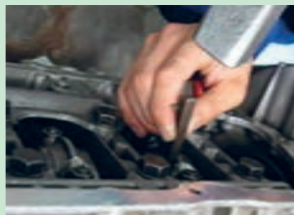
شکل ۴۱. علامت زدن کپه شاتون
