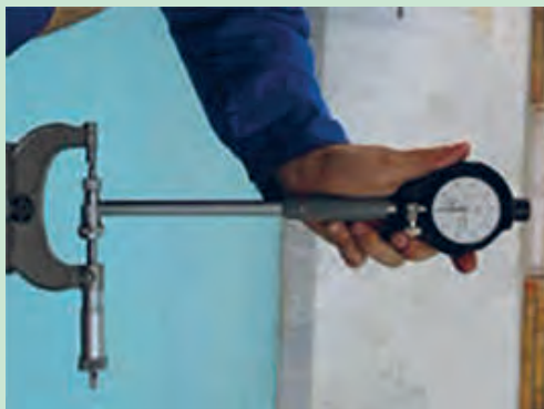
شکل ۶۳. کنترل دو په‌نی تکیه‌گاه‌های میل‌لنگ
