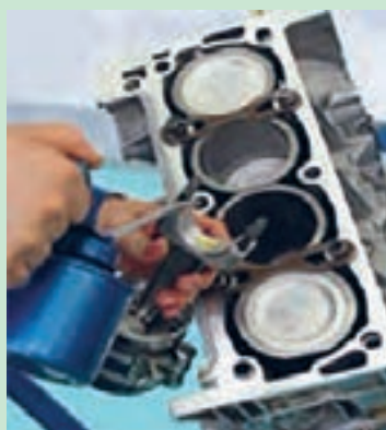
شکل ۱۰۱. روغن کاری کپه یاتاقان شاتون
