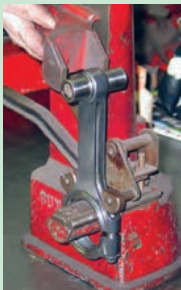
شکل ۸۲. پیچیدگی شاتون، اندازه گیری و اصلاح آن
