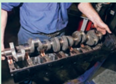
شکل ۴۹. برداشتن میل لنگ
