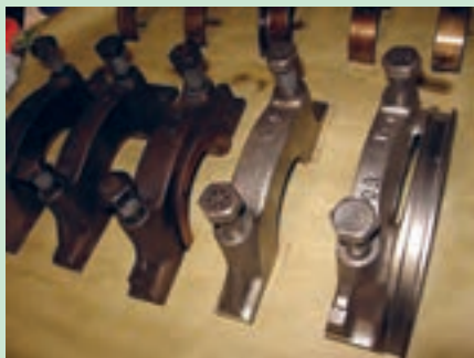
شکل ۴۸. برداشتن کپه های یاتاقان و چیدن آنها
