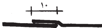
شکل ۲۰-۳ - لایه های قیرگونی در تمام نقاط باید به یکدیگر متصل و ۱۰ سانتیمتر بر روی یکدیگر پوشش ایجاد نمایند. این عمل به منظور جلوگیری از نفوذ آب از محل تلاقی صفحات عایق کاری می باشد.
