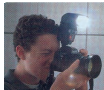
شکل ۱-۳۰ انرژی فلاش دوربین در یک خازن ذخیره شده است.
