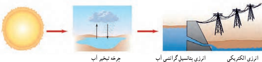
شکل ۹- انرژی پتانسیل گرانشی آب پشت سد توسط توربین‌ها و مبدل‌ها به انرژی الکتریکی تبدیل می‌شود.
