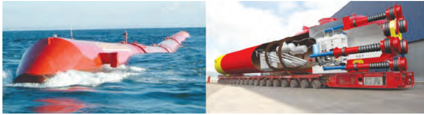
شکل ۸- این دستگاه دراز و مارمانند در واقع توربینی است که برای بهره‌برداری از انرژی موج‌های دریا ساخته شده است.
