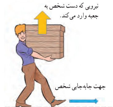
شکل ۴- وقتی نیرو بر جهت جابه‌جایی عمود باشد، کاری انجام نمی‌دهد.
