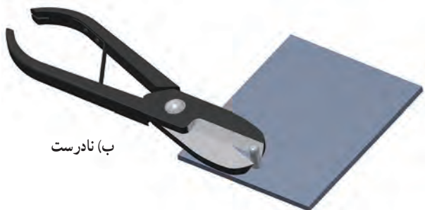
شکل ۸-۱- روش استفاده از قیچی
