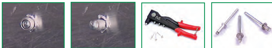
الف- میخ پرچ ب- دستگاه پرچ کاری پ- قطعه قبل از پرچ کاری ت- قطعه بعد از پرچ کاری
