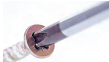
الف) استفاده صحیح از آچار پیچ گوشتی
