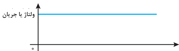
شکل ۸- ولتاژ خروجی نیروگاه خورشیدی
