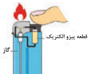
شکل ۱۲ (ج) - کاربرد پیزوالکتریک در فندک
