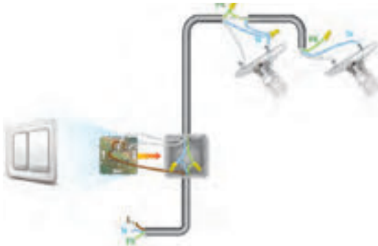
شکل ۲۷ - مدار کلید دوراهه (دوبل)
