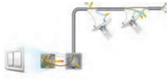
شکل ۲۷ - مدار کلید دوراهه (دوبل)
