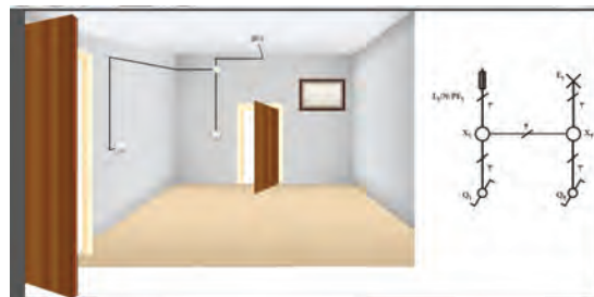
شکل ۳۶ - کاربرد مدار تبدیل
