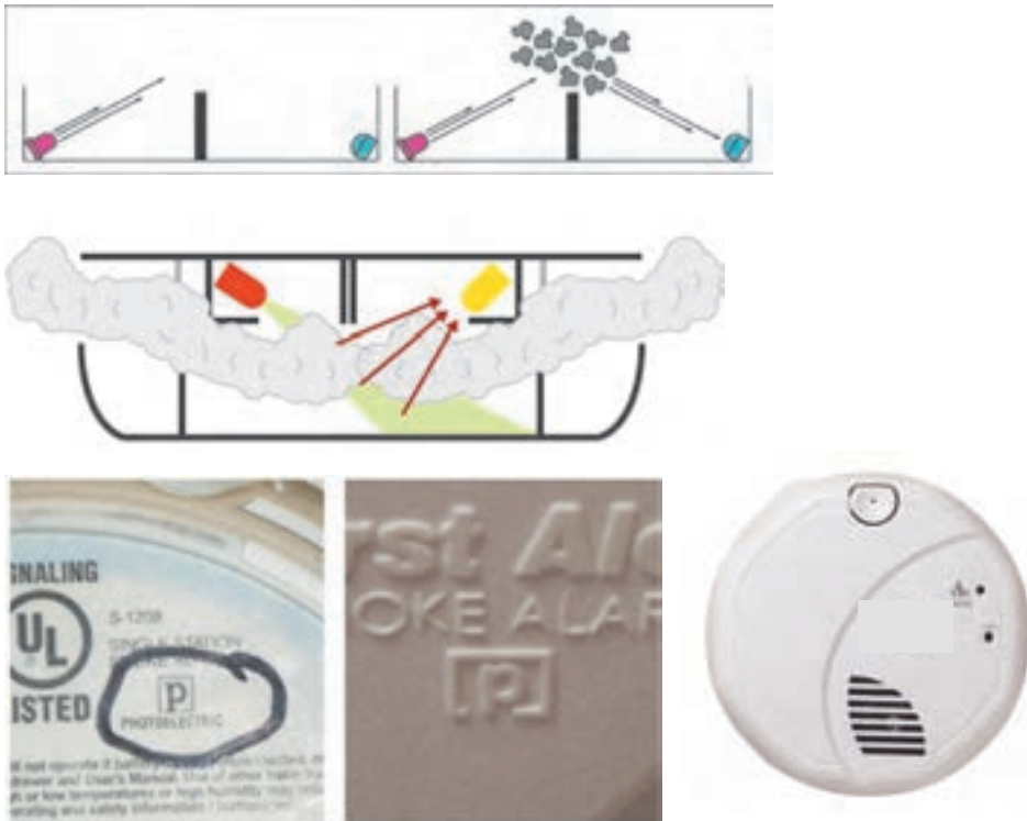
شکل ۳۲ - عملکرد دتکتور دودی و علامت مشخصه آن
