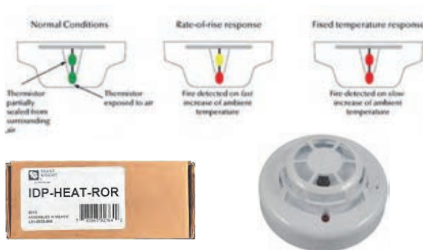
شکل ۴۳ - برچسب روی جعبه دتکتور سمت چپ و نحوه عملکرد دتکتور
