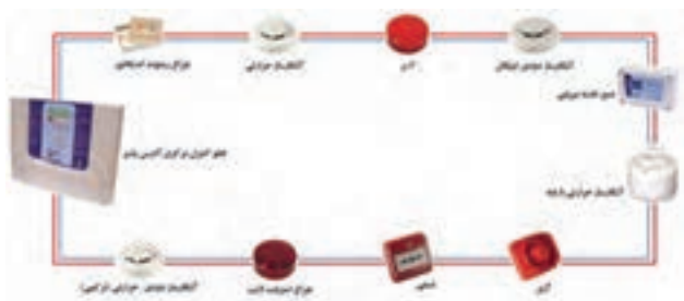
شکل ۳- سیستم اعلام حریق آدرس پذیر
