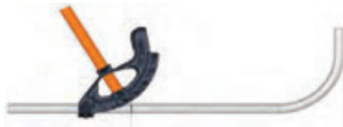
شکل ۲۷- اجرای خم دوم
