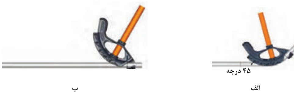
شکل ۳۳- خم انحرافی با لوله خم‌کن دستی
