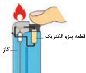
شکل ۱۲ (ج) - کاربرد پیزوالکتریک در فندک
