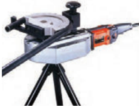
شکل ۱۷- خم کردن لوله
