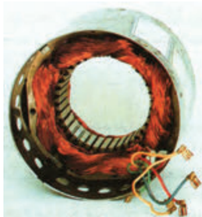
شکل ۷۰- سرسیم‌ها و سیم‌پیچی‌های موتور الکتریکی کولر آبی
