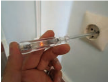
شکل ۴ - کاربرد صحیح فازمتر
