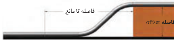
شکل ۳۵- هم‌راستا کردن امتداد لوله
