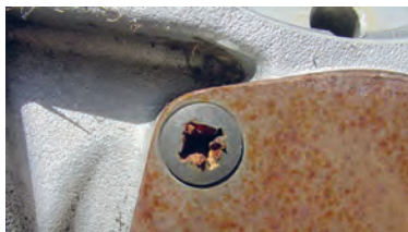
ب) استفاده ناصحیح از آچار پیچ گوشتی
