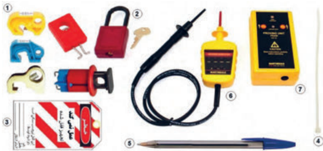
شکل ۵۱- تجهیزات لازم برای جداسازی ایمن
