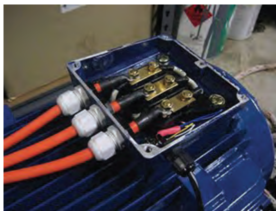
ج) گلند در اتصال به تخته کلم موتور الکتریکی
