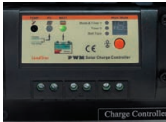
شکل ۳۶- با اتصال باتری LED روشن می شود.
