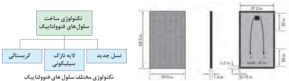
شکل ۷- ابعاد مدول خورشیدی و تکنولوژی آن
