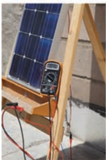
شکل ۱-۱۵ اندازه‌گیری ولتاژ بی‌باری
