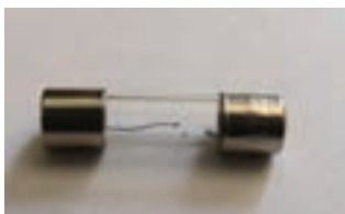
شکل ۴۹- فیوز سر راه باتری سوخته است.
