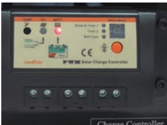
شکل ۳۶- با اتصال باتری LED روشن می شود.
