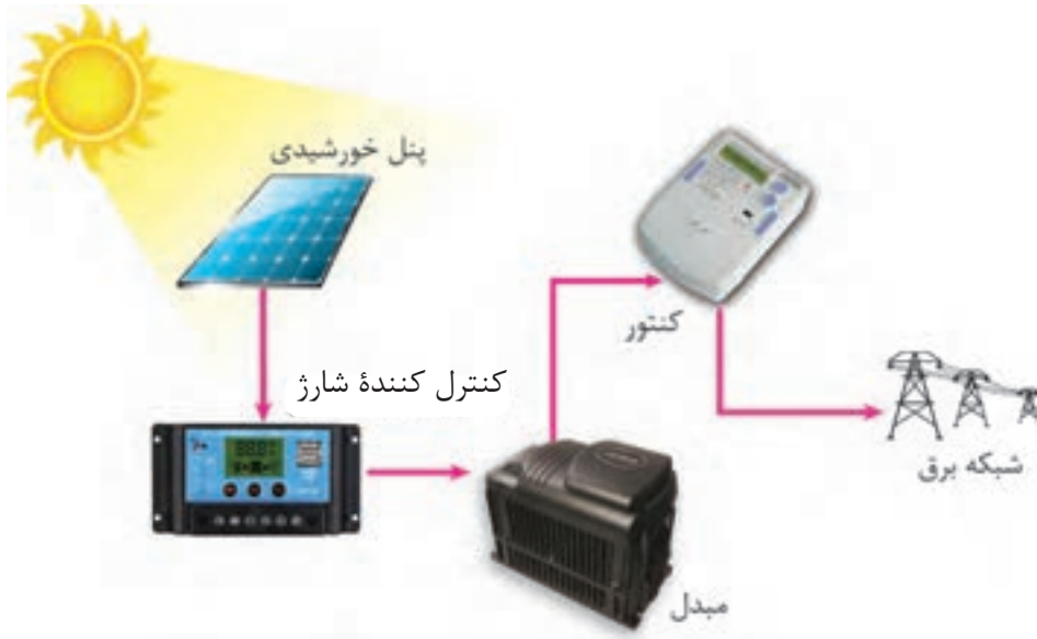
شکل ۵۱- نقشه ارتباط عناصر سیستم فتوولتائیک On_Grid
