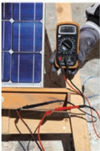
شکل ۲-۱۵ اندازه‌گیری جریان اتصال کوتاه
