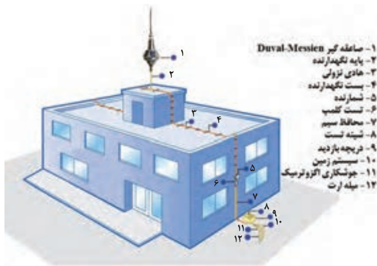
شکل ۴۱- تجهیزات صاعقه گیر
