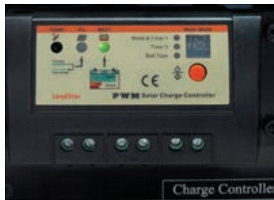
شکل ۳۶- با اتصال باتری LED روشن می شود.
