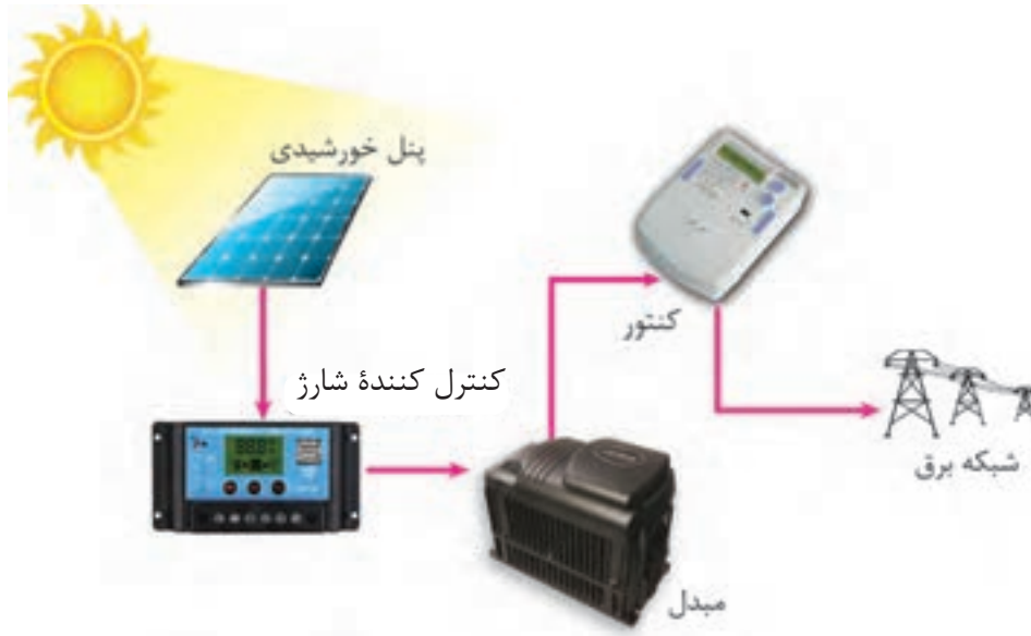
شکل ۵۱- نقشه ارتباط عناصر سیستم فتوولتائیک On_Grid
