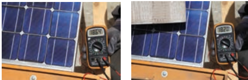
شکل ۷- الف - اثر سایه بر ولتاژ بی‌باری
