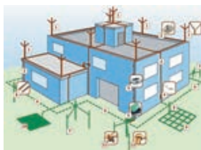
شکل ۳۸ – پراکنده کردن صاعقه در زمین
