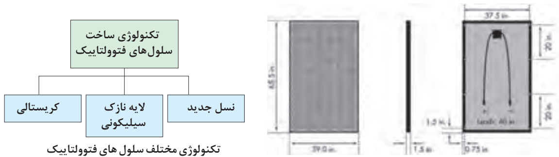
شکل ۷- ابعاد مدول خورشیدی و تکنولوژی آن
