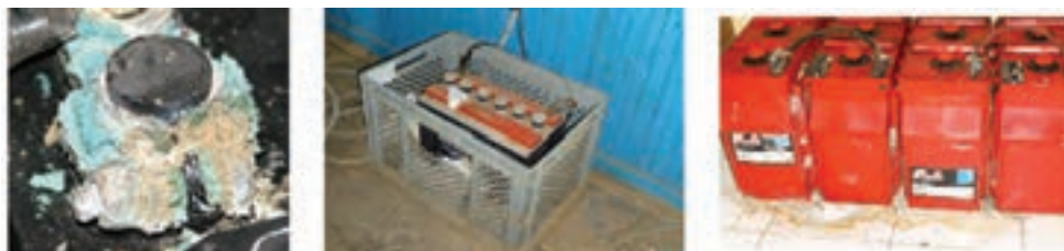
شکل ۲۱- سولفاته و نشستی باتری
