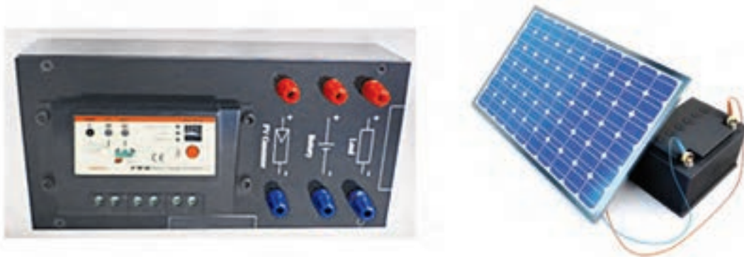
شکل ۱۳- اتصال مستقیم باتری به مدول
