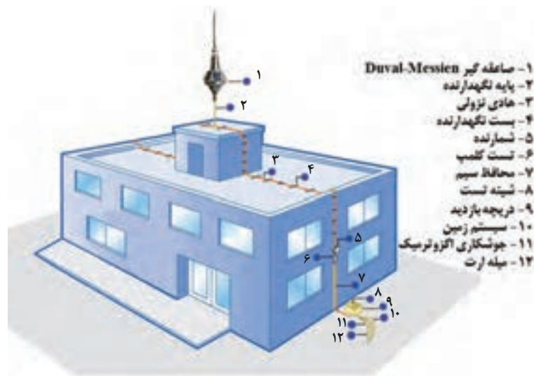
شکل ۴۱- تجهیزات صاعقه گیر
