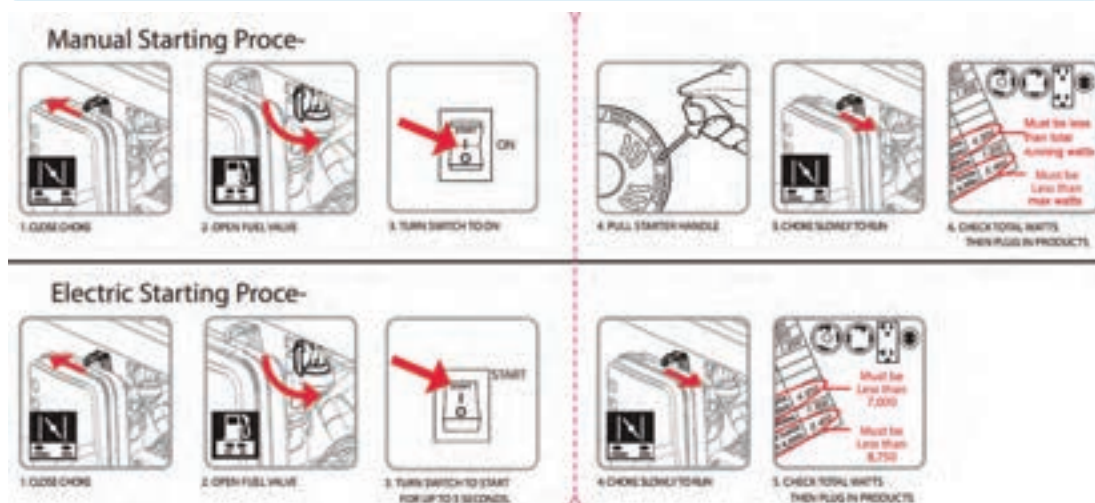
شکل ۲۱- مراحل تست و راه اندازی موتور ژنراتور
