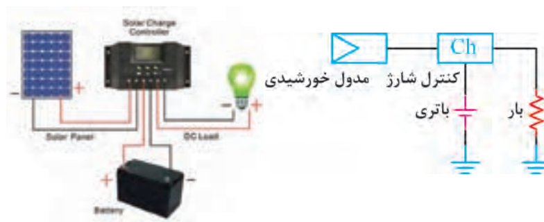
شکل ۳۳- یک نمونه کنترل کننده شارژ باتری (اتصال و شمای فنی)
