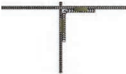
نحوه جوشکاری میل‌گردها در یک تقاطع سه راهه
