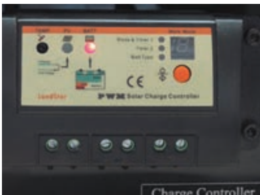
شکل ۳۶- با اتصال باتری LED روشن می شود.
