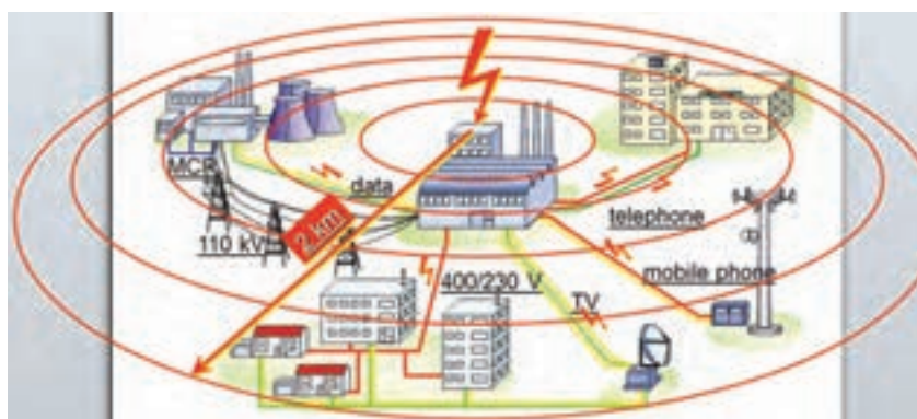
شکل ۳۳ - میدان الکترومغناطیسی ناشی از صاعقه
