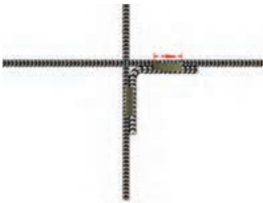
نحوه جوشکاری میل‌گردها در یک تقاطع چهار راهه
