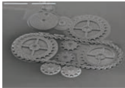
شکل ۲-۳۵- مکانیزم چرخ و زنجیر MEMS
