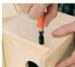
شکل ۲۷-۴ - خزینه کاری دستی
