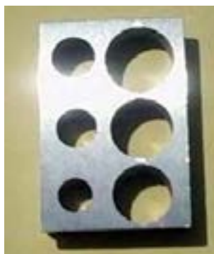
شکل ۲۱-۴- قطعه کار پس از عملیات برقوکاری
