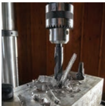
شکل ۳۰-۳- عملیات سوراخ کاری قبل از برقوکاری
