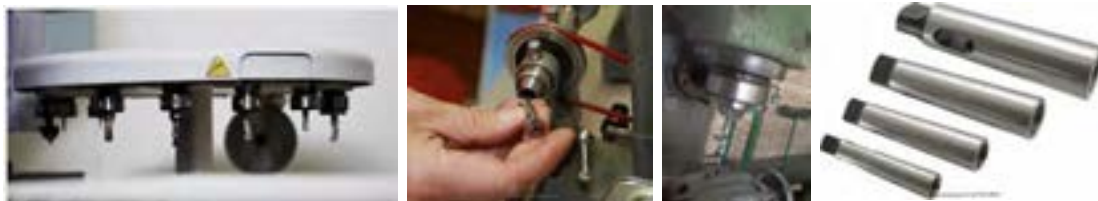
شکل ۴-۲- کاربرد سوراخ مخروطی در دستگاه‌های فرز
