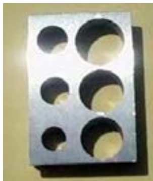
شکل ۲۱-۴- قطعه کار پس از عملیات برقوکاری
