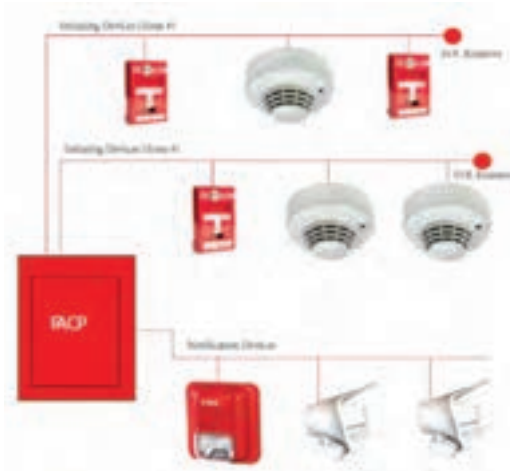
اعلام حریق متعارف
