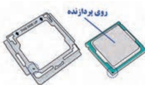
شکل ۳۴- نشانه روی پردازنده و سوکت
