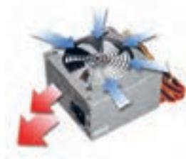
شکل ۲۳- جهت تهویه هوا در منبع تغذیه
