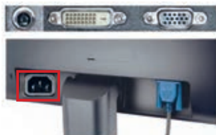
شکل ۴- محل اتصال کابل‌های صفحه نمایش
