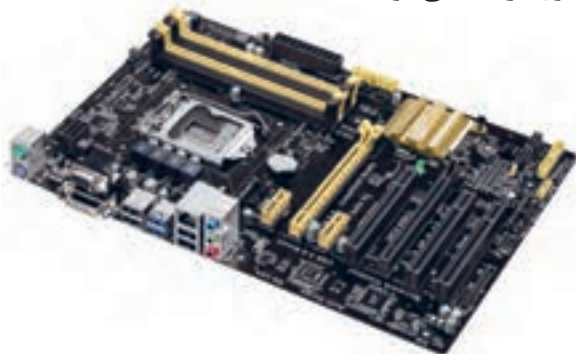
شکل ۸ - برد اصلی با فرم فاکتور ATX
