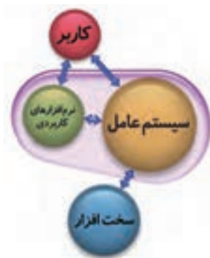
شکل ۱۹- ارتباط کاربر-نرم‌افزار کاربردی-سیستم‌عامل-سخت‌افزار
