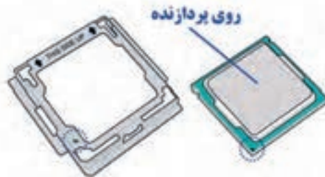
شکل ۳۴- نشانه روی پردازنده و سوکت
