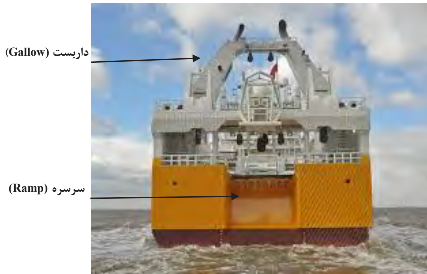
شکل ۵۰- تصویر یک کشتی ترالر پاشنه کش و موقعیت سرسره و داربست آن از سمت پاشنه
