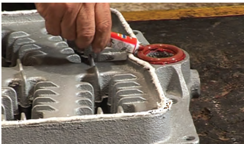
شکل ۲۰- استفاده از اورینگ به جای بوش
