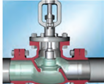
شیر کف فلزی (Globe Valve)
