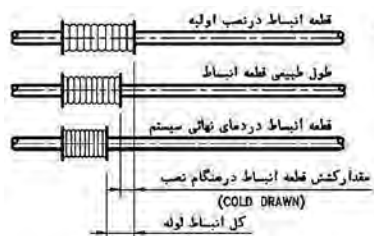
شکل ۱۹- لوله انبساط گیر
