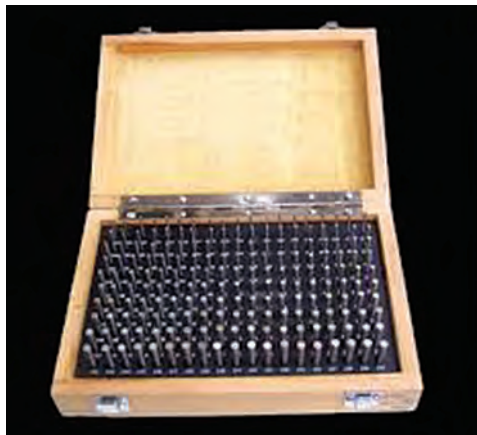
شکل ۵۴ - گیج پین و روش کنترل
