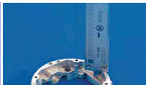
شکل ۵۲ - عمق‌سنج کولیس
