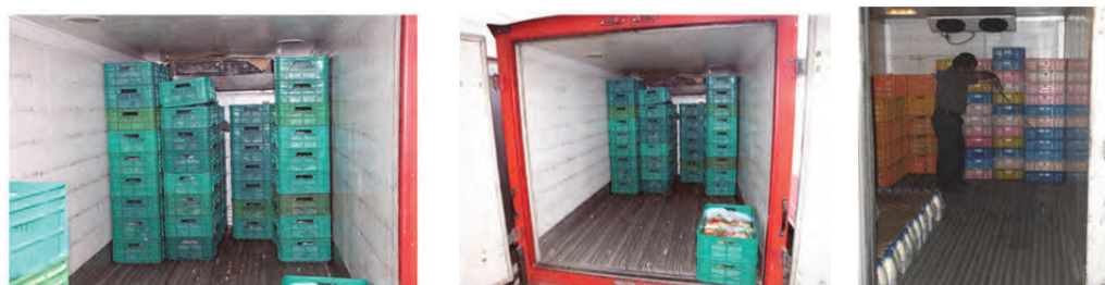
شکل ۲۸- روش چیدمان کالاهایی که با سبد حمل می‌شوند.
