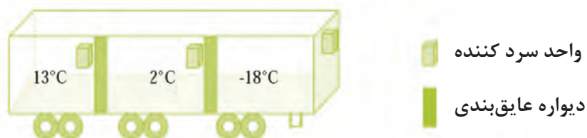
شکل ۲۰- نمای شماتیک از کانتینر با دماهای مختلف پشت سرهم
