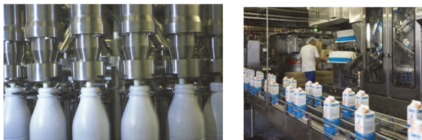
شکل ۳۱- بسته‌بندی به روش آسپتیک
