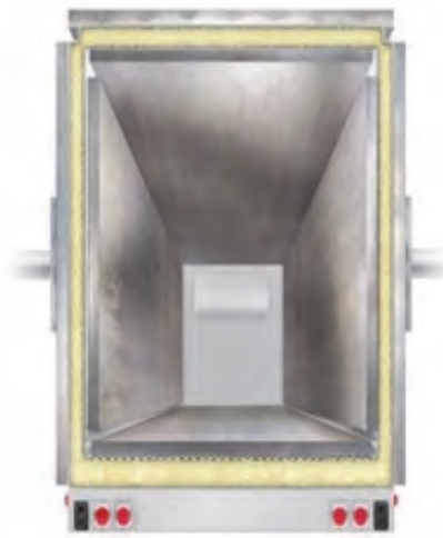
شکل ۷- اتاق عایق‌بندی شده
