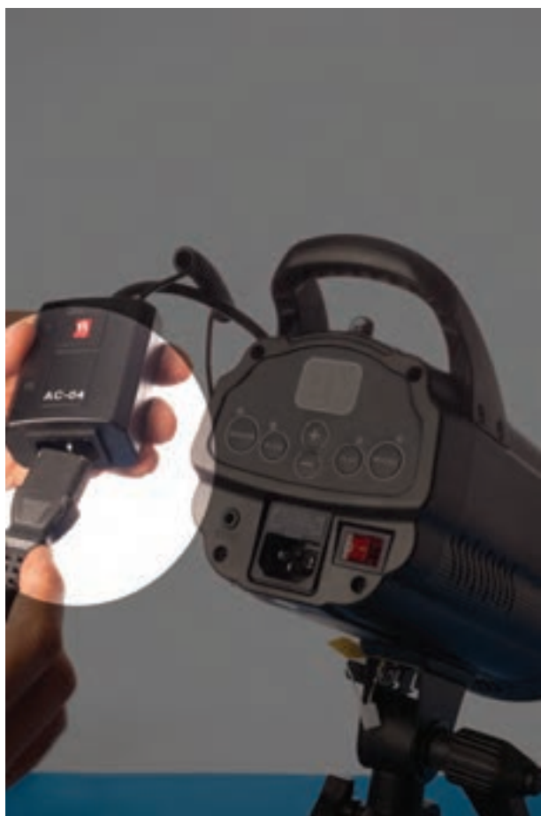
▲ اتصال گیرنده رادیو تریگر به برق در مدل‌های برقی | تصویر ۱۳۴
