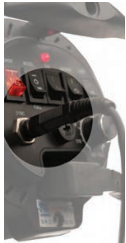
▲ تصویر ۱۹۶ | اتصال سیم سینکرون به فلاش
