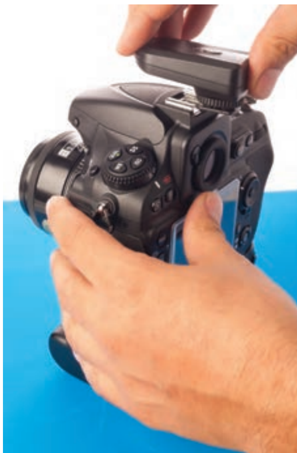
▲ اتصال ریموت فرستنده به دوربین | تصویر ۱۳۵
