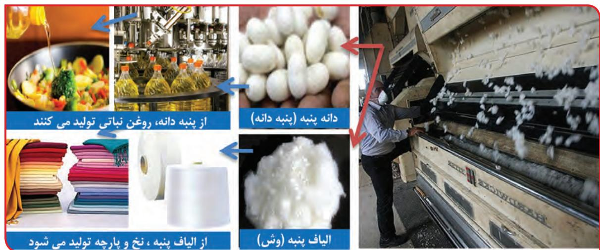
در کارخانه پنبه پاک کنی، دانه ها و الیاف از یکدیگر جدا می شوند. دانه ها به کارخانه های روغن کشی و الیاف به کارخانه های رسندگی و بافندگی فرستاده می شوند.
