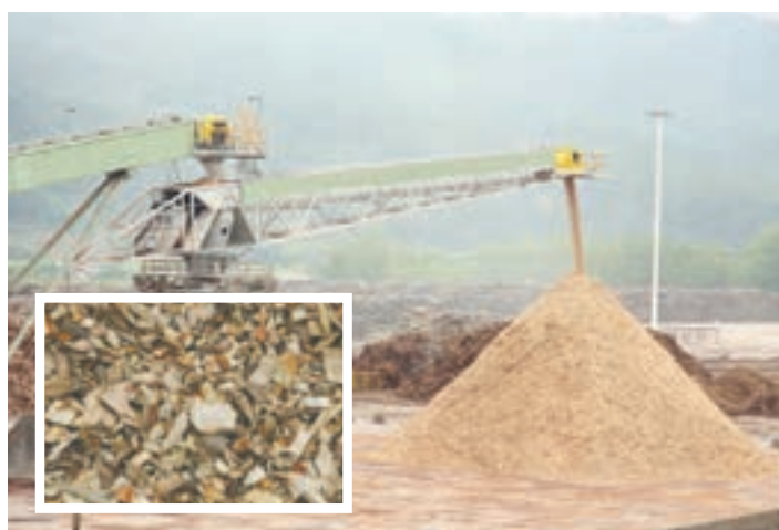
(۴) تبدیل به تکه‌های ریز چوب (چیپس چوب)
