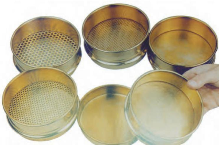
شکل ۱-۲۱—۱ انواع الک که در تجزیه مکانیکی خاک مورد استفاده قرار می گیرند.
