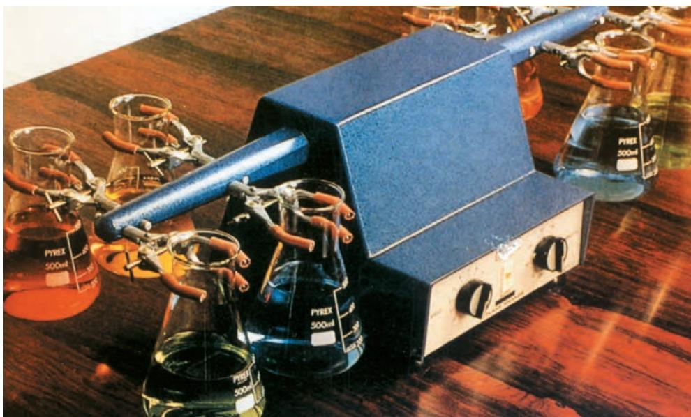
شکل ۶ - ۲ یک نوع دستگاه بهمزن الکتریکی
