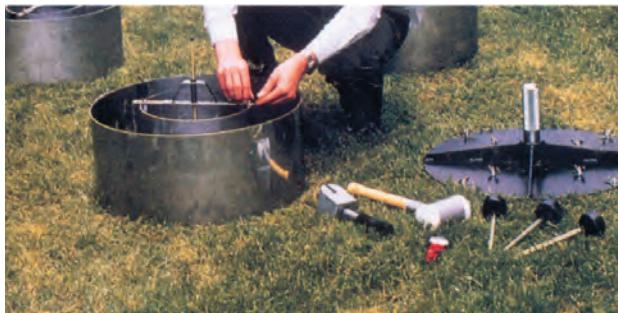
شکل ۱-۳۰ نحوه کارگذاشتن استوانه مضاعف
