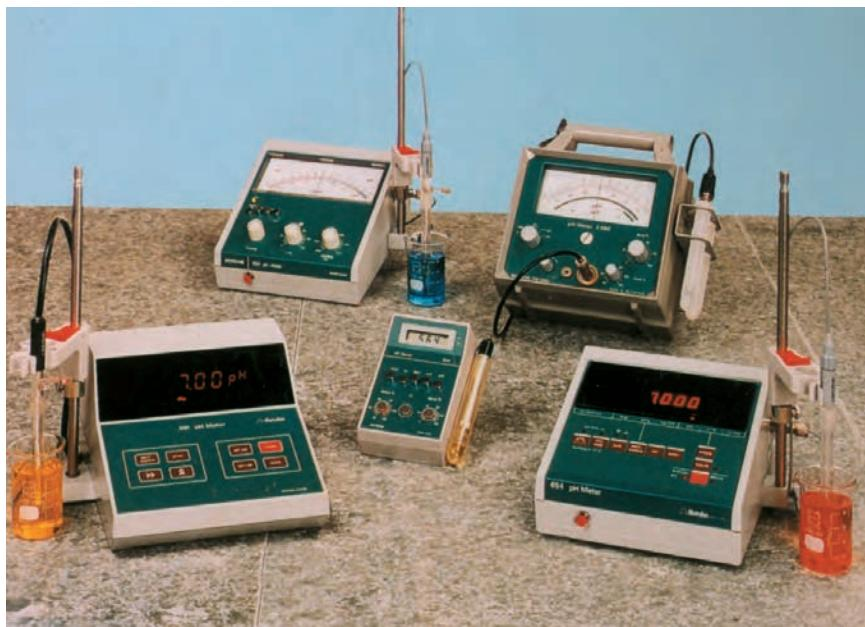
شکل ۱۰ - pH متر الکتریکی
