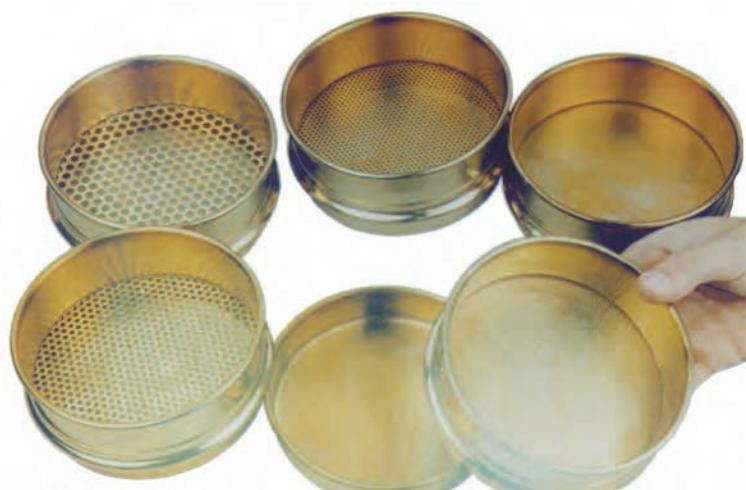
شکل ۱-۲۱— انواع الک که در تجزیه مکانیکی خاک مورد استفاده قرار می گیرند.
