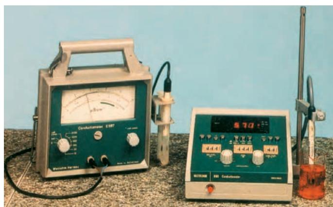
شکل ۱۱ - ۲ دستگاه تعیین هدایت الکتریکی
